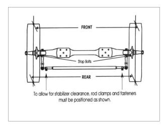
**Figure 32 -** Composilite<sup>TM</sup> Alignment
